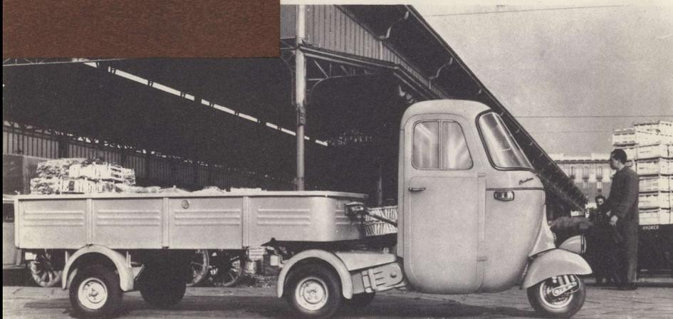
La motrice può circolare separatamente dal semirimorchio e può essere quindi utilizzata per traini diversi. Questa peculiare caratteristica del Pentarò permette di abolire i tempi morti dovuti al carico ed allo scarico delle merci. Il Pentarò è dotato di avviamento e tergicristallo elettrici, martinetto, borsa attrezzi, ruota di scorta.
